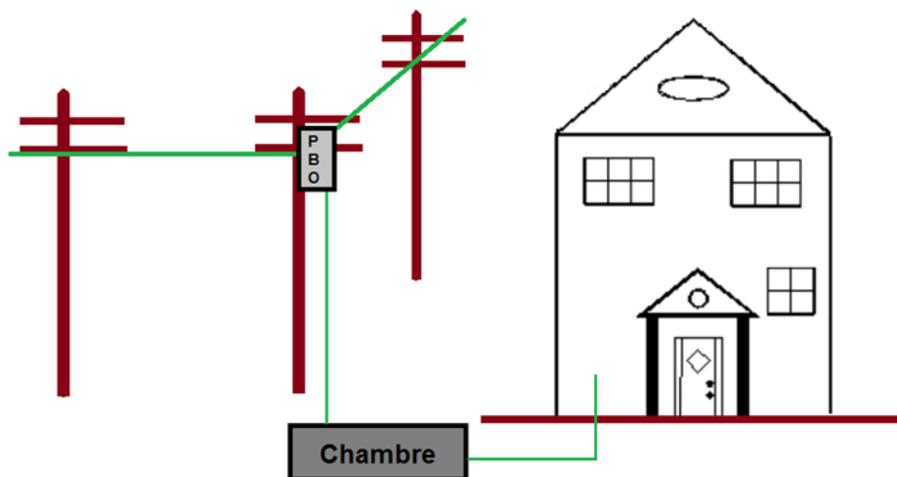
L'adduction peut aussi être réalisée à partir d'un PBO sur poteau. Le câble de branchement descend alors le long du poteau pour emprunter un cheminement souterrain (câble en conduite existante ou à faire installer) vers l'habitation (via une chambre/regard ou non, en pied de poteau).
