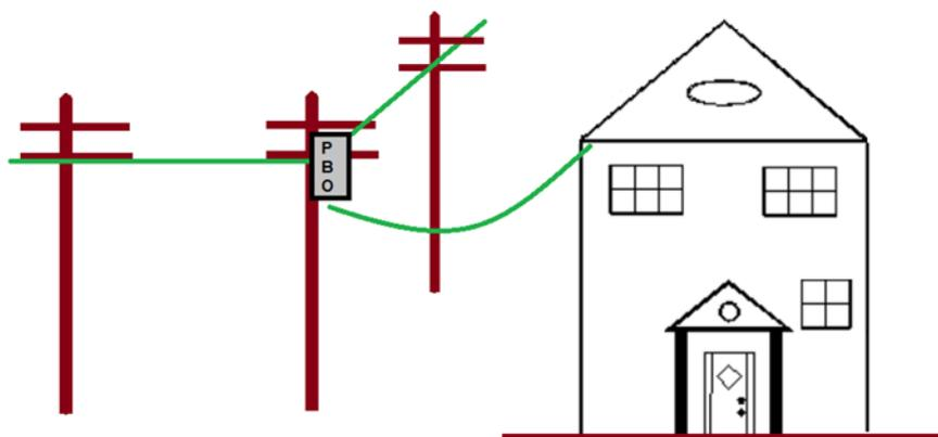
Une fixation du même type que celle posée au poteau pourra être fixée au mur du pavillon à raccorder, puis un percement sera effectué pour rentrer le câble chez l'abonné avec ou sans cheminement en façade.
