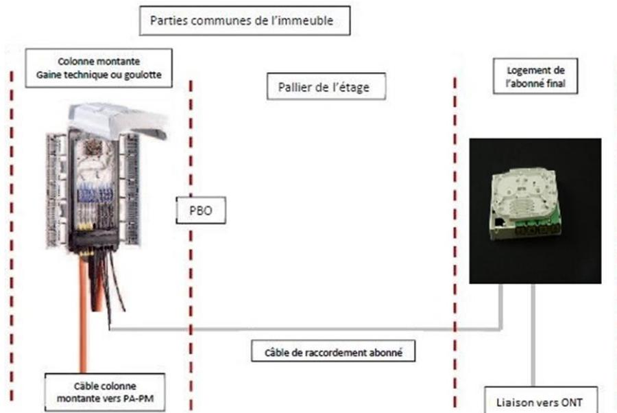
Le raccordement du logement couvre l'ensemble des opérations de pose d'un câble dit de raccordement d'abonné, d'installation et de raccordement des matériels optiques associés, depuis le point d'entrée du logement jusqu'au PBO.
